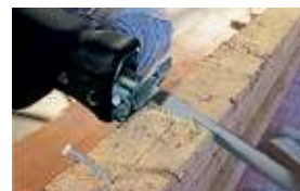
Пиление древесины с гвоздями Артикул 0615 . 722 . 842
